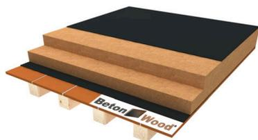
Sistema completo a secco per solai con pannelli in fibra di legno densità 160 kg/m<sup>3</sup> FiberTherm su mezzane in cotto e struttura in legno. Ottimo sistema per isolamento termo-acustico di solai non calpestabili.
