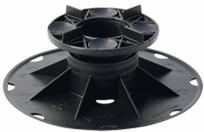
**Supporti autolivellanti SB** Supporti regolabili per tetti ventilati sopraelevati tipo "Basic", regolabili in altezza. I supporti sono costituiti da elementi in polipropilene composti da una base di appoggio del diametro minimo di mm. 205e da una vite con testa avente altezza variabile da mm. 27 a mm. 120. Nella base sono presenti dei fori per il deflusso dell'acqua e n. 4 linee "guida" per facilitare il taglio in caso di necessità.
